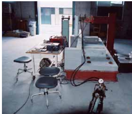
実物大静的載荷試験状況
