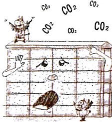
①炭酸ガスによるモルタルの中酸化(注6)
