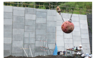
鉄球衝突実験 静岡県富士市施工技術研究所
